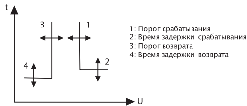
Принцип действия функции защиты от перенапряжения
